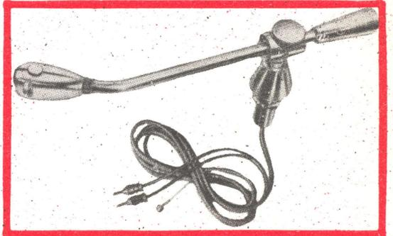
Il braccio stereofonico della Rek-O-Kut. Si noti la vite godronata che regola la posizione del contrappeso, onde scegliere il peso sulla punta più indicata, a seconda della testina impiegata.
