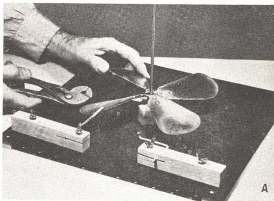
Guida per il controllo e l'allineamento delle pale
