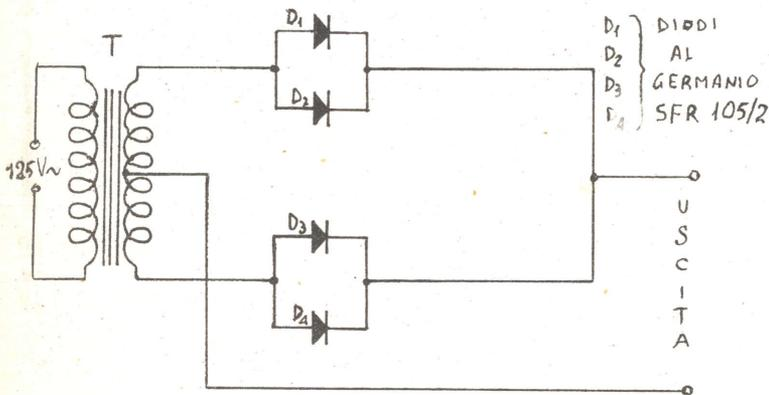
T trasformatore primario 125/220V secondario 20+20V
