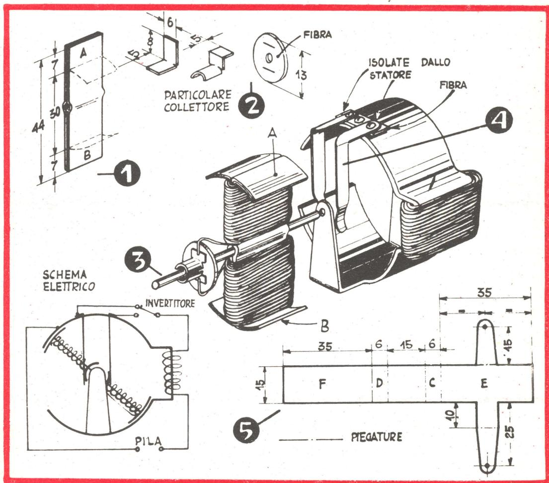
poi fissato allo statore a mezzo di una piccola vite o con qualche giro di nastro isolante, avendo cura che le spazzole risultino a leggero contatto con le lamine del collettore e che siano bene isolate dalla massa.
