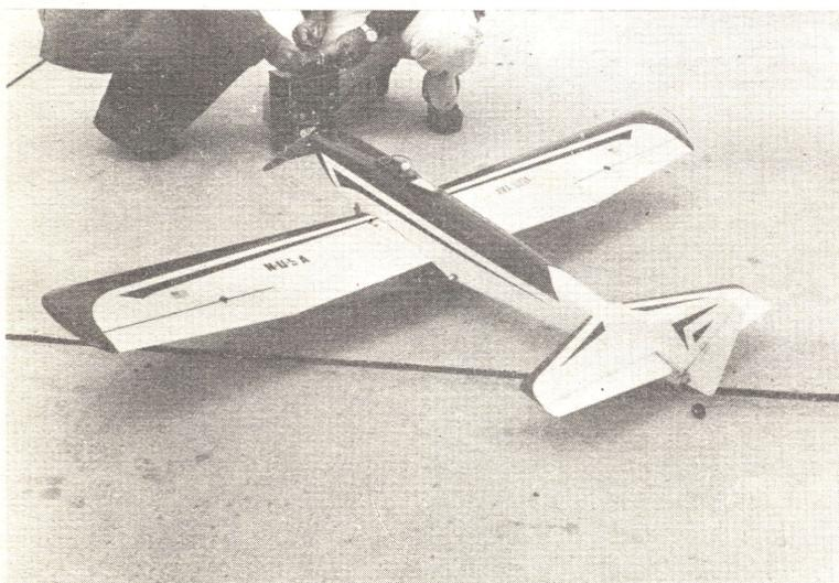
Il famoso «Orion» di Kazmirski che, dopo aver conquistato il Campionato Mondiale nel 1960 a Zurigo, ha costituito uno dei punti basilari nello sviluppo del moderno modello radiocomandato. Gli alettoni sono disposti alle estremità alari, con incernierature sulla superficie ventrale; ma nel suo nuovo modello, il «Taurus», anche Kazmirski è passato agli alettoni lungo tutta l'apertura alare.
