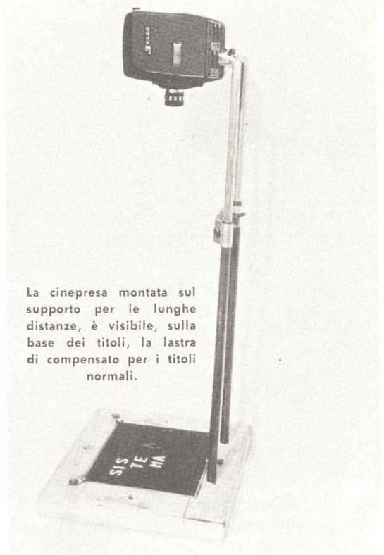
La cinepresa montata sul supporto per le lunghe distanze, è visibile, sulla base dei titoli, la lastra di compensato per i titoli normali.
