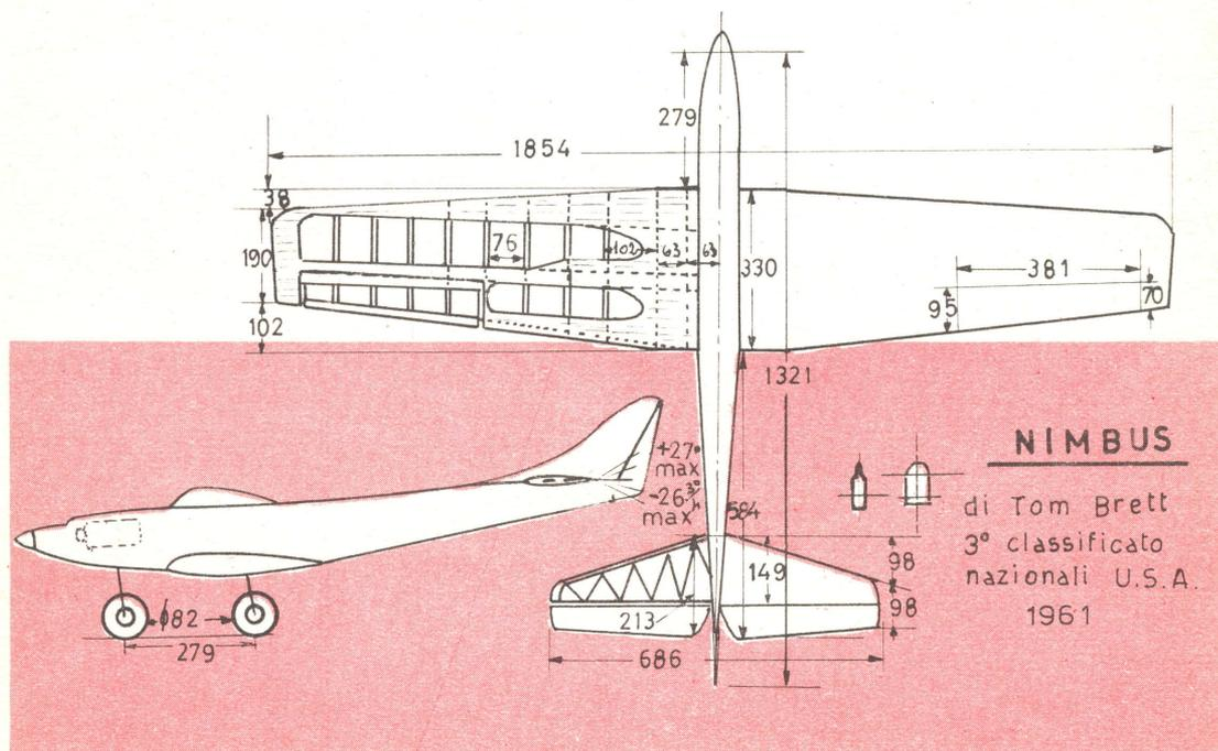
L'ala originale del Nimbus aveva la rastremazione distribuita, parte sul bordo d'entrata, parte su quello d'uscita, e gli alettoni piazzati su parte dell'apertura alare, per una superficie pari al 10,5% di quella alare.
