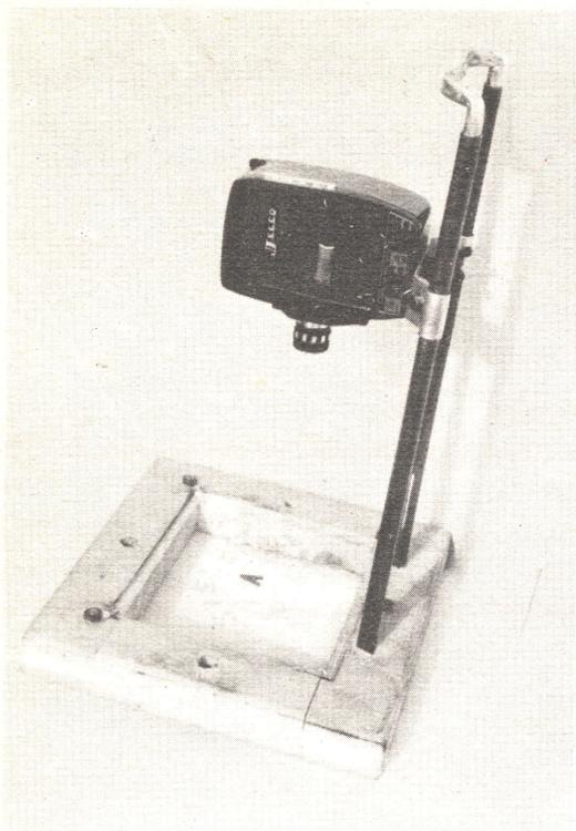
La cinepresa montata sul supporto per le distanze ravvicinate. E' visibile, sulla base dei titoli, la strada di vetro per i titoli in trasparenza.
