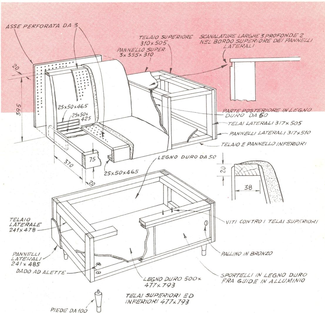
Per unire i pezzi delle intelaiature usate colla e chiodi. I pannelli del sedile e dello schienale sono in legno duro perforato da 32 mm.
