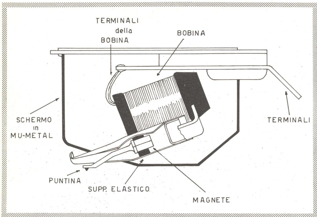
Costituzione della testina a magnete mobile di produzione della Elac. Si possono rilevare tutti gli elementi costruttivi descritti nel testo.
