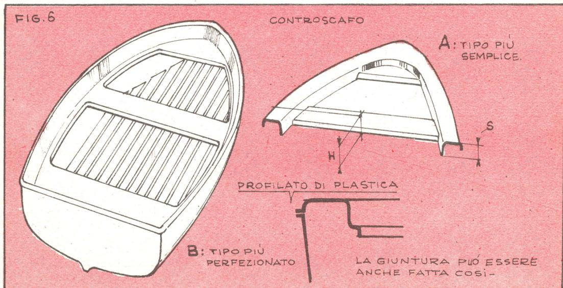
Asciugato il gesso e levigate le superfici del modello, si dà un buon distaccante (alcol polivinilico) e si stratifica lo stampo nel modo abituale, e cioè gel-coat e vetroresina. Per uno stampo che venga adoperato due o tre volte, basteranno due strati di mat da 450 gr/mq., irrigidito con una tralicciatura in tubi di ferro, bloccati fra loro con saldatura autogena o con legatura di filo di vetro e resina.
