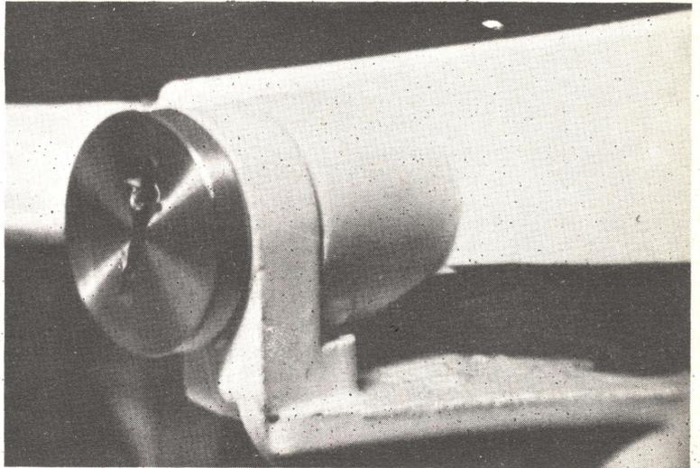
produttore. Schematicamente esso è costituito da un perno, posto a conveniente distanza dal piatto, su cui è libero di ruotare un braccio, di forma e dimensioni le più svariate, alla cui estremità è una calotta, contenente la testina riproduttrice. Lungo il braccio, all'interno per motivi estetici, corrono i fili di prelievo del segnale, che escono poi alla base del perno; a tal fine esso si presenta bucatato.
