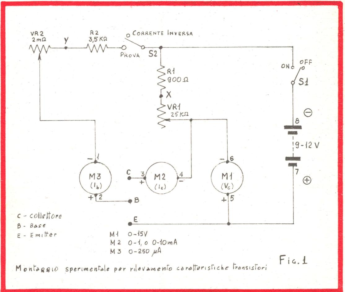
7) Ripetere le operazioni 5 e 6 per un numero sufficiente di valori, riportandoli di volta in volta su un foglio di carta millimetrata e unendoli con tratti di matita; si otterranno così i grafici di fig. 4 e 5.
